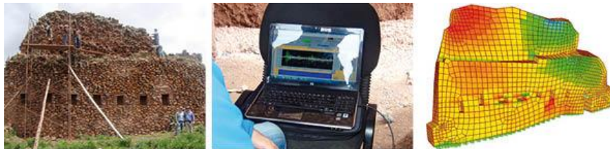
Figura 2: Medición de vibraciones en el muro de Chokepukio, Cusco, Perú. Figura 3: Fachada principal del Templo de San Pedro Apóstol Andahuaylillas.
